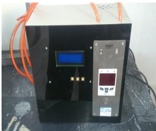
شکل ۳- اختلاف فشارسنج Fig.3. Differential pressure meter
