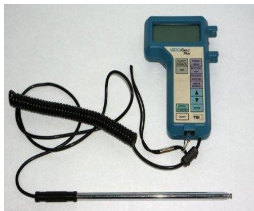
شکل ۲- سرعت‌سنج هوای سیم داغ Fig.2. Hot wire anemometer
