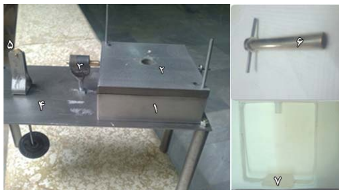
شکل ۳- قسمت‌های مختلف دستگاه برش مستقیم میوه: (۱) فک پایینی، (۲) فک بالایی، (۳) راهنما، (۴) میز کار، (۵) قرقره، (۶) نمونه‌گیر و (۷) محل قرارگیری وزنه
