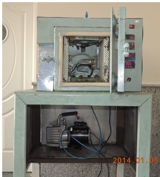
شکل ۲- خشک‌کن خلأ مجهز به کنترل‌کننده دما و حسگر فشار مطلق (Kamali, 2011)
