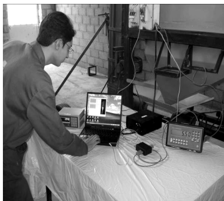
شکل ۵- تصویری از کارکرد حسگر ضربه‌ای، داده برداری و ثبت اطلاعات حسگر از طریق رایانه
