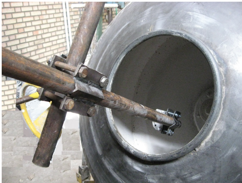
شکل 5- پایه ساخته شده برای تنظیم فاصله و زاویه قرارگیری افشانک Fig. 5. Made device to adjust the distance and angle of nozzle
