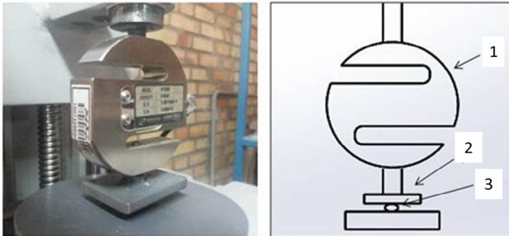
شکل 4- دستگاه تست کشش - فشار موجود در آزمایشگاه خواص فیزیکی پردیس ابوریحان چپ: تصویر واقعی راست: تصویر شماتیک 1- نیروسنج 2- پروب 3- بذر پوشش‌دار
