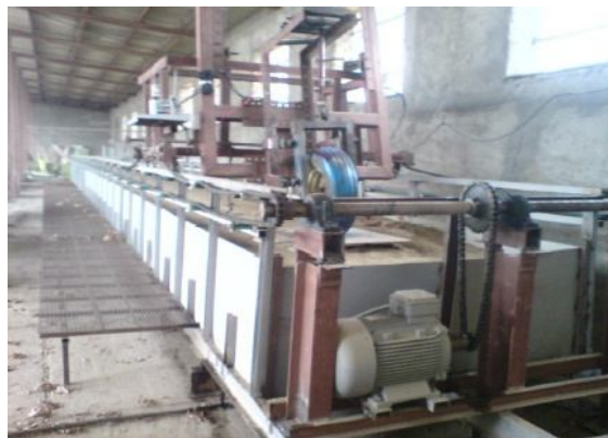
شکل ۱- آزمونگر تک چرخ و انباره خاک مورد استفاده در آزمون‌های تجربی Fig.1. One-wheel tester and soil-bin used in experimental tests
