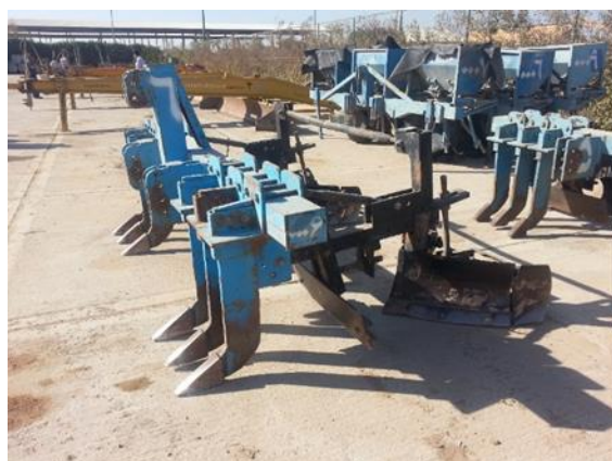
شکل ۴- دستگاه مخصوص به روی پشته بردن نیشکر شماره یک Fig.4. Hilling up device No. 1
