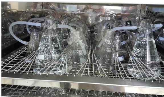
شکل ۱- نحوه قرارگیری بطری‌ها جهت اندازه‌گیری زیست‌گاز تولیدی
