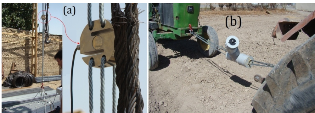
شکل ۳- (a) روش مورد استفاده در واسنجی نیروسنج سامانه (b) روش RNAM در اندازه‌گیری مقاومت کششی گاوآهن Fig. 3. a) Utilized method to calibrate the load measuring apparatus of the system b) the RNAM method to measure plow draft
