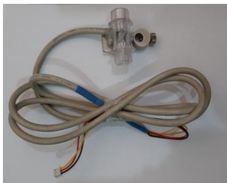
شکل ۳- کنتور الکترونیکی نصب‌شده در مسیر خروج محلول سم از سمپاش و کالیبراسیون آن Fig.3. Electronic meter installed for the pesticide solution exit from the sprayer
