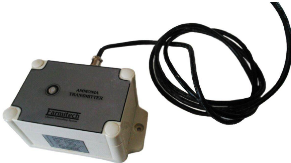
شکل ۳- ماژول اندازه گیری آمونیاک با سنسور آمونیاک مدل RS485 Fig.3. Measuring ammonia concentration module using RS485 sensor
