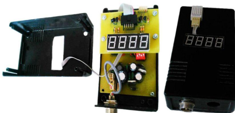
شکل ۱- ماژول اندازه‌گیری دما و رطوبت با سنسور AM2303
