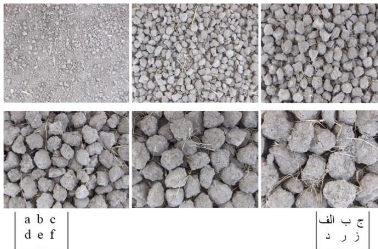
شکل ۲- نمونه‌ای از تصویر لنز چپ دوربین استریو از شش کلاس موجود: تصاویر به ترتیب از کوچک‌ترین خاک‌دانه (الف؛ ردیف بالا گوشه چپ) تا درشت‌ترین آن‌ها (ز؛ ردیف پایین گوشه راست) نمایش داده شده‌اند.
