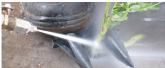
شکل ۲- آزمایش برش ساقه علف به وسیله جت آب
