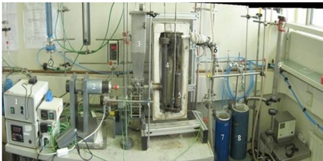
شکل ۱- تصویر سیستم پیرولیز بستر سیال؛ (۱) منبع تغذیه، (۲) موتور تغذیه، (۳) مخزن، (۴) رآکتور، (۵) مخزن زغال، (۶) چگالنده، (۷) تله سرمایشی، (۸) تله سرمایشی نهایی، (۹) تله الکترواستاتیک
