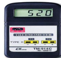
شکل ۲- ترمومتر دیجیتالی جهت اندازه‌گیری دمای نمونه چوبی
