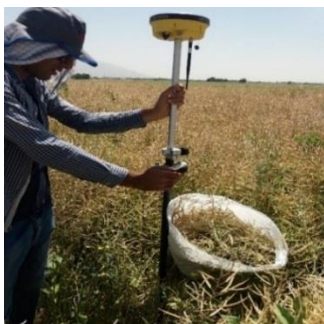
ه- تعیین موقعیت دقیق نمونه‌ها با کمک دستگاه RTKGPS E. Recording exact location of the samples by RTKGPS
