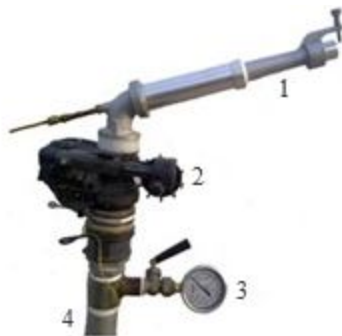
شکل ۳- سامانه آبیاش آماده شده برای ارزیابی مزرعه‌ای؛ (۱) آبیاش نرخ متغیر ساخته شده، (۲) جعبه دنده، (۳) فشارسنج، (۴) رایزر
