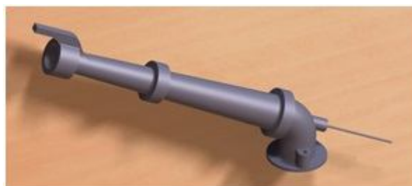
شکل ۲ - آبپاش طراحی شده در نرم افزار Catia Fig.2. Sprinkler designed in Catia software
