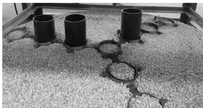
شکل ۴- راهنمای Y شکل و استوانه‌های نمونه‌برداری
