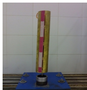
شکل ۲- دستگاه ساخته شده برای آزمون‌های ضربه
