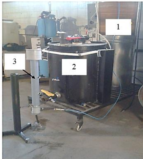
شکل ۱- مجموعه هاضم تولید بیوگاز، مخزن ذخیره گاز و بیوفیلتر (۱- مخزن ذخیره بیوگاز، ۲- هاضم تولید بیوگاز و ۳- بیوفیلتر) Fig.1 Digester, biogas storage, and biofilter (1- Biogas storage, 2- Digester, 3- Biofilter)
