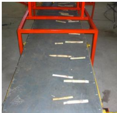
شکل ۵- آرایش قرارگیری قلمه‌ها بر روی زمین (بستر متحرک) Fig. 5. Arrangement of the sugarcane scions on the grand (conveyor belt)
