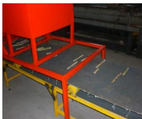
شکل ۶- توزیع مناسب ریزش قلمه توسط موزع Fig. 6. Suitable distribution of the sugarcane scions by the distributor unit
