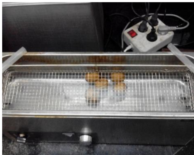
شکل ۱- اعمال امواج فراصوت بر نمونه گردوها Fig.1. Ultrasound waves exertion on walnut samples
