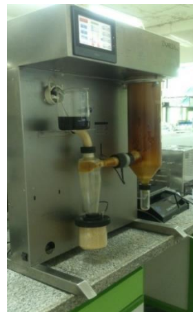
شکل ۱- خشک‌کن پاششی مورد استفاده در این تحقیق Fig.1. The spray dryer used in this research
