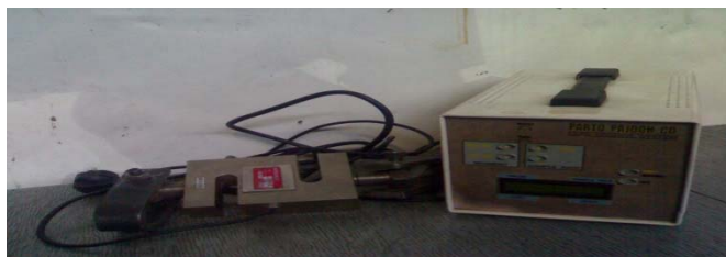
شکل ۳- نیروسنج و دیتالاگر مورد استفاده در آزمایش کشش تراکتورها
