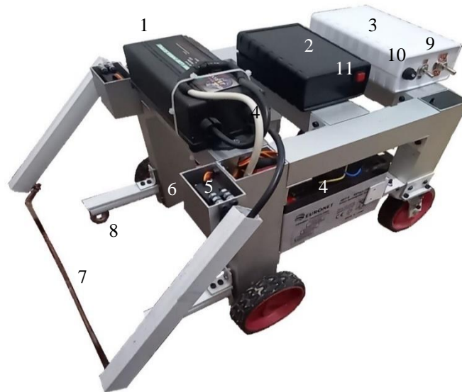
شکل ۳- سکوی روباتیک خودگردان برای نابودگر علف هرز با سازوکار بازخوردی (۱- افزایش ولتاژ بالا، ۲- جعبه پردازش، ۳- جعبه تغذیه، ۴- باتری، ۵- سروموتور، ۶- موتور دنده‌ای، ۷- الکتروود ولتاژ بالا، ۸- الکتروود زمین، ۹- کلیدهای روشن و خاموش، ۱۰- فیوز، ۱۱- دکمه راه‌اندازی مجدد)
