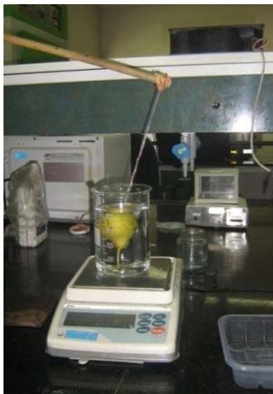
شکل ۲- روش غوطه‌وری برای تعیین چگالی
