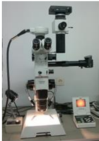
شکل ۳- استریو میکروسکوپ مدل Olympus SZX12 با لنز شی ای X1 و بزرگ‌نمایی ۷ برابر Fig.3. Olympus SZX12 stereo microscope with X1 objective lens and 7x magnification
