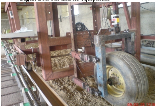
شکل ۲- آزمونگر تک چرخ در انباره خاک
