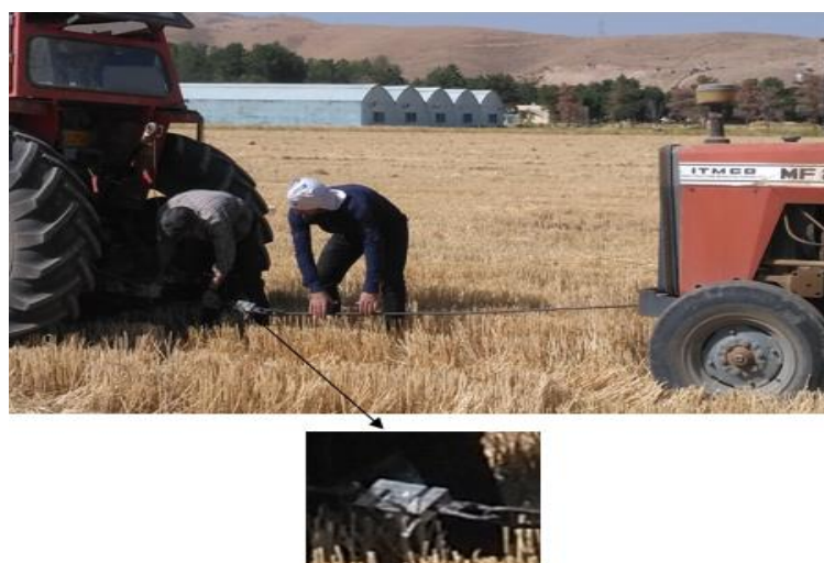
شکل ۲- آزمایش دو تراکتوری برای اندازه گیری نیروی کشش Fig.2. (a) RNAM method of measuring the draft by two tractor
