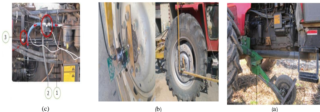
شکل ۳- نمایش دورسنج متصل به (الف) چرخ پنجم، (ب) چرخ عقب تراکتور، (ج) دبی‌سنج‌های استفاده شده (۱- جهت حرکت سوخت، ۲- دبی‌سنج اول، ۳- دبی‌سنج دوم)
