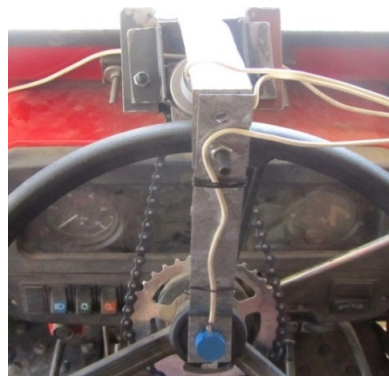
شکل ۱- محل قرارگیری پتانسیومتر بر روی فرمان تراکتور Fig.1. The location of potentiometer on the tractor steering wheel
