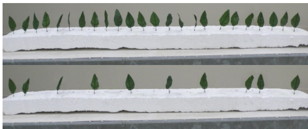
شکل ۹- ردیفی از بوته‌های مصنوعی با تراکم ۲۴ بوته در هر ۱۶۰ سانتی‌متر، (بالا) قبل از تنک‌کاری و (پایین) بعد از تنک‌کاری
