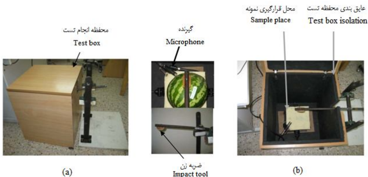
شکل ۱- (a) سامانه آزمون ضربه‌ای مورد استفاده، (b) نحوه قرارگیری نمونه‌ها در سامانه آزمون صوتی Fig.1. (a) Schematic of the applied impact apparatus, (b) Sample location in the acoustic testing system
