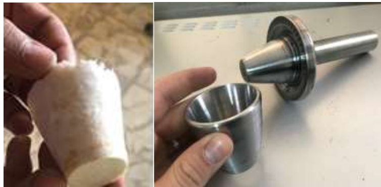
شکل ۱- قالب ساخته شده برای ساخت یک لیوان و نمونه لیوان ساخته شده
