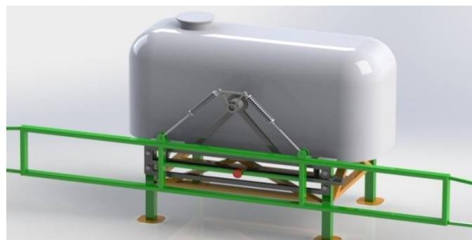
شکل ۷- سم‌پاش با سامانه متعادل فعال Fig.7. Sprayer with active balance system
