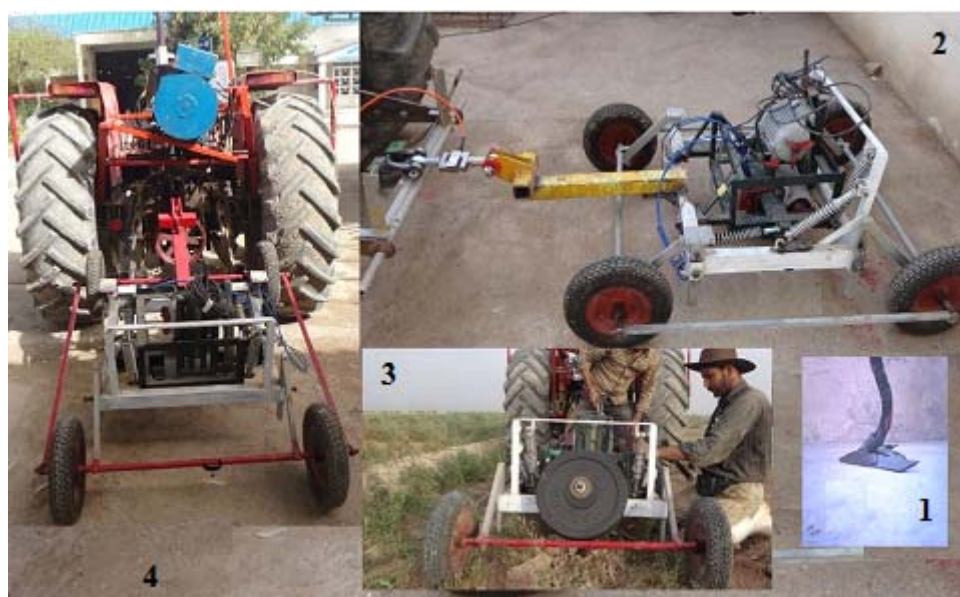
شکل ۱- (۱) تیغه و ساقه‌ی خاک‌ورز، (۲) آرایش فنرها، (۳) سنگین‌کننده، (۴) نمای خاک‌ورز آزمایشی Fig.1. (1) Tillage blade and stem, (2) Sort springs (3) Ballasting, (4) The experimental tiller
