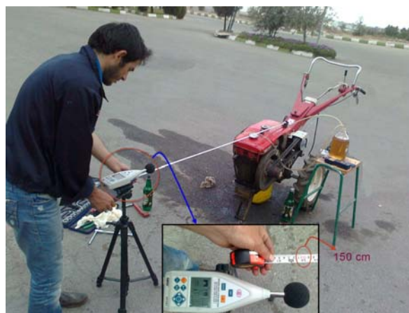
شکل ۱- اندازه‌گیری صدا در موقعیت ۱/۵ متری آگروز Fig.1. Noise measurement at 1.5 m away from the exhaust
