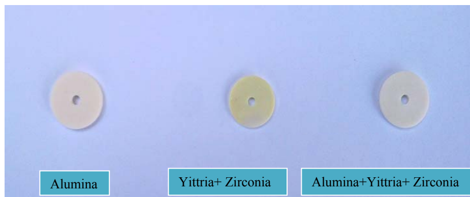
شکل ۲- نمونه نهایی افشانک‌ها پس از عملیات حرارتی تف جوشی Fig.2. Final sample of nozzles after sintering operation
