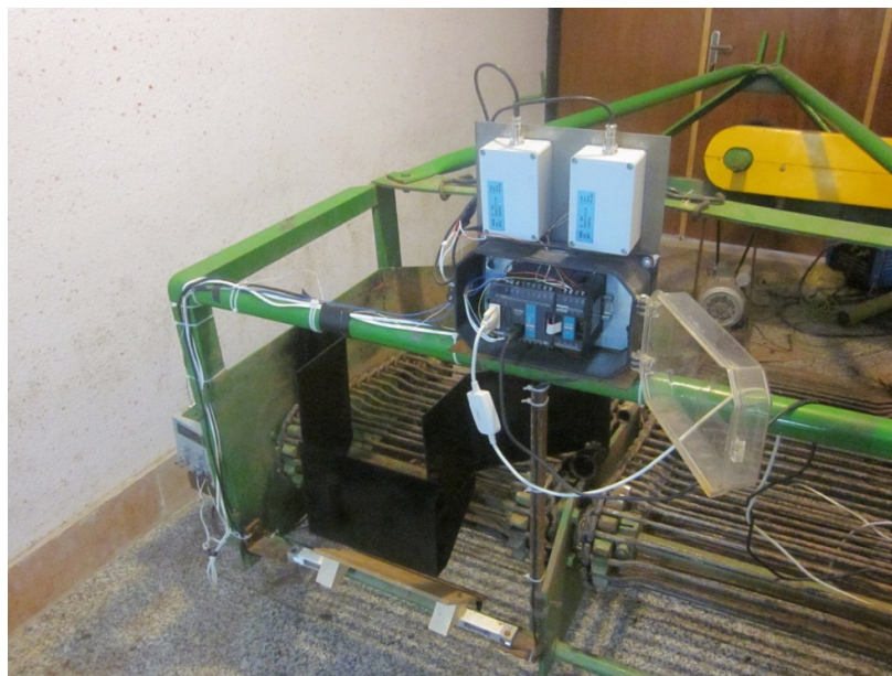
شکل ۲- ماشین برداشت سیب‌زمینی زنجیر نقاله‌ای به همراه تجهیزات مورد استفاده
