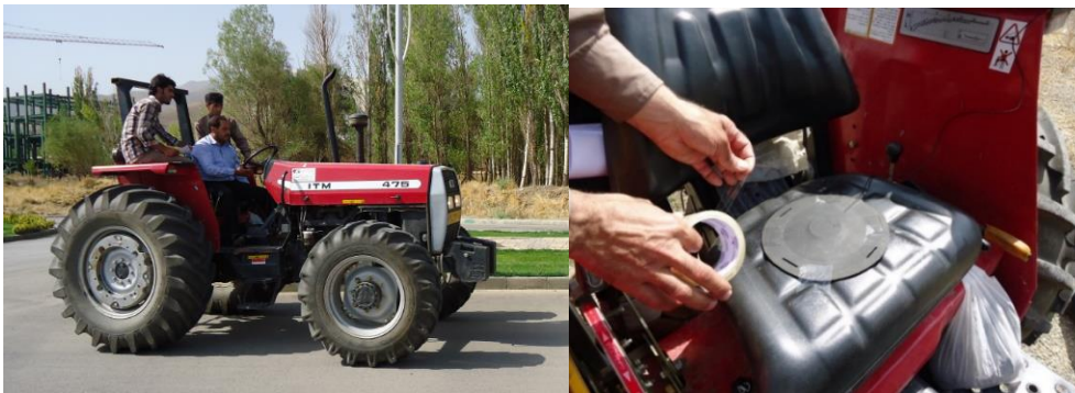
شکل ۲- صندلی تراکتور و اتصال تجهیزات اندازه‌گیری ارتعاش (راست) و اندازه‌گیری ارتعاش صندلی تراکتور حین حرکت بر روی جاده آسفالت (چپ)
