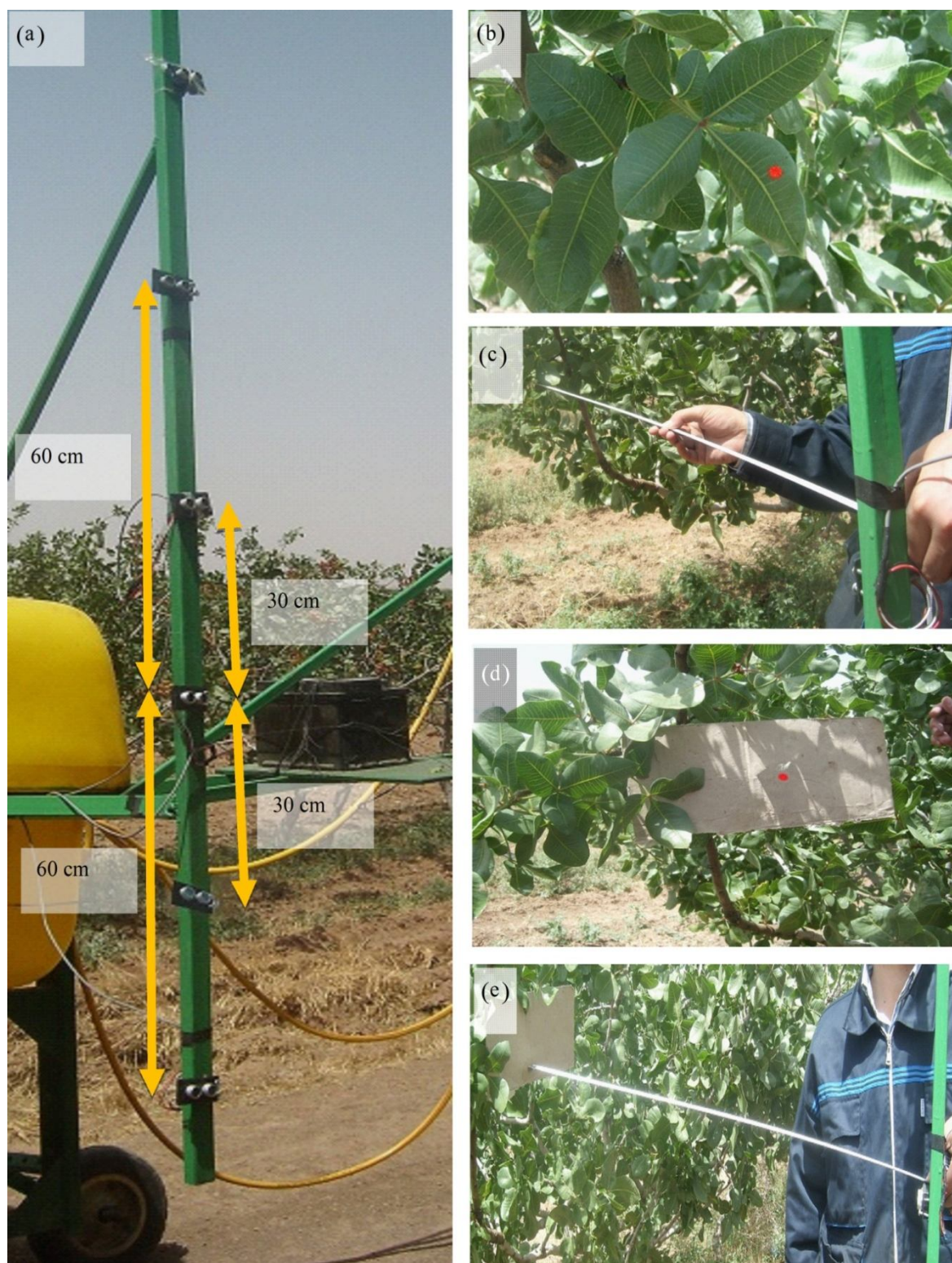
شکل ۵- (a) دکل عمودی به همراه حسگرهای فراصوتی برای اندازه‌گیری فاصله و بررسی اثر تداخل، (b)، (c)، (d) و (e) مراحل متوالی برای بررسی فاصله
