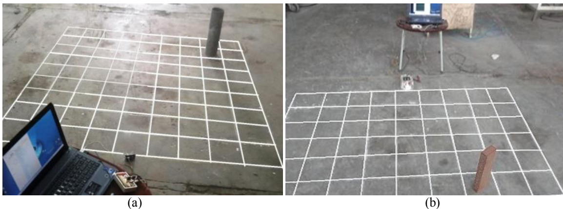
شکل ۴- آزمون تعیین ناحیه دید واقعی حسگرهای فراصوتی با اجسام گرد و تخت؛ (a) سطح انحنادار، (b) سطح تخت
