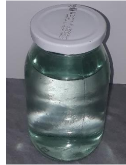
شکل ۱۱- نمونه آب خروجی از سامانه آب شیرین کن خورشیدی برای کیفیت سنجی
