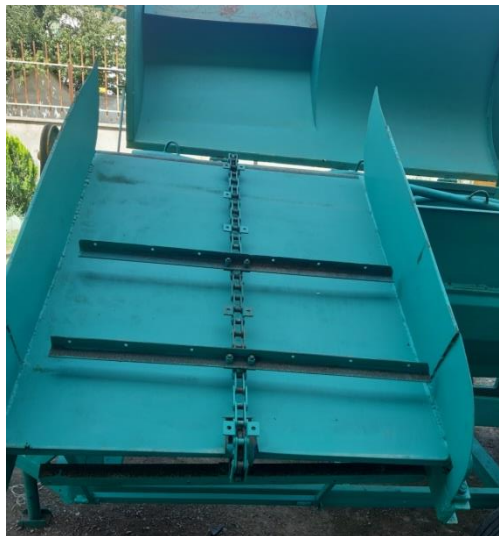
شکل ۲- تغذیه‌کننده محصول به قسمت کوبنده
