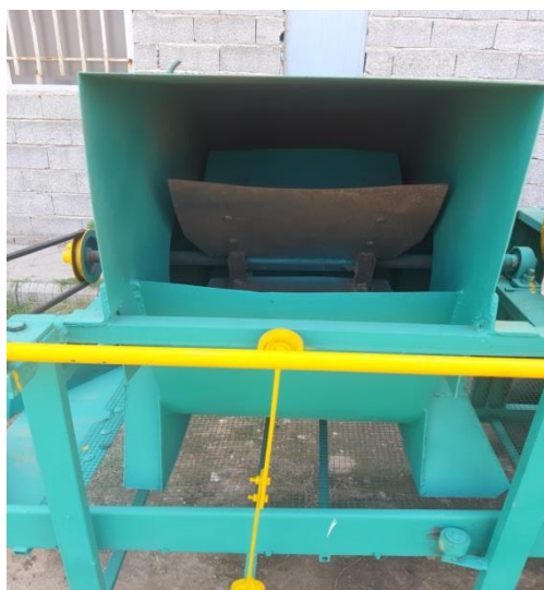
شکل ۵- فن مکند که مواد اضافی از قبیل ضایعات و شاخه و برگ‌ها را از غلاف‌های بادام‌زمینی جدا می‌کند Fig.5. Suction fan that separates excess material such as waste and twigs from peanut pods
