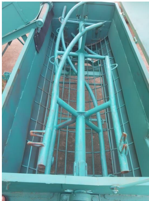
شکل ۳- ترکیب کوبنده و ضدکوبنده Fig.3. Thresher-concave arrangement
