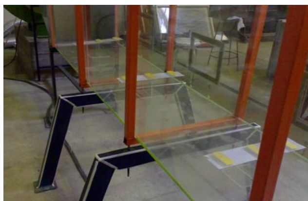
شکل ۵- نحوه‌ی قرارگیری کاغذهای حساس به آب در داخل کانال تونل باد Fig.5. The placement of water-sensitive paper in the wind tunnel
