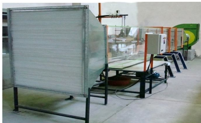
شکل ۳- تونل باد مادون صوت باز برای مدل سازی تجربی بادبردگی قطرات سم در شرایط کنترل شده‌ی جریان هوا Fig.3. Subsonic open wind tunnel for experiments modeling of toxin droplet drift in controlled conditions of air flow
