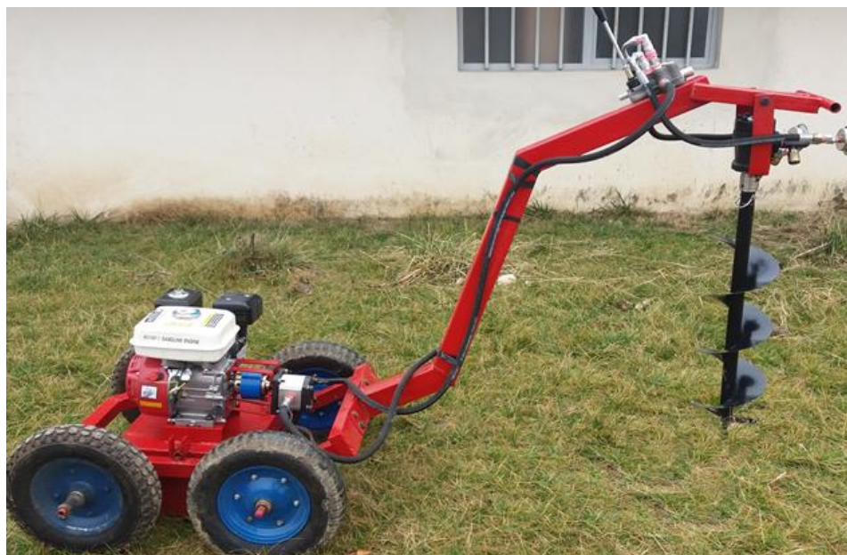
شکل ۴- گودال‌کن هیدرولیکی ساخته شده
