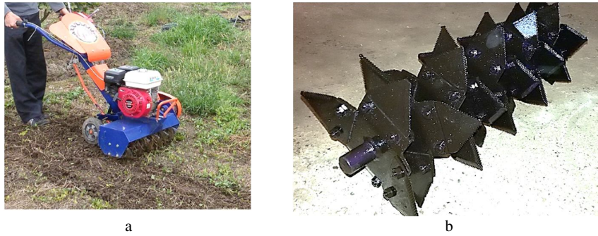
شکل 1- (a) روتوتیلر مورد استفاده در آزمایش و (b) تیغه‌های مورد استفاده در روتوتیلر Fig. 1. (a) Rototiller used in the experiments, and (b) Blades of the rototiller
