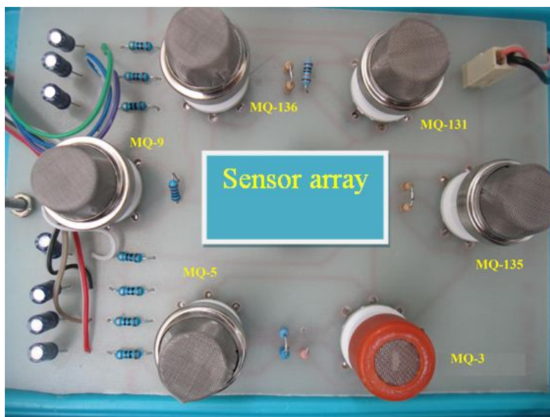
شکل ۳- مداربندی آرایه حسگری سامانه طراحی شده
