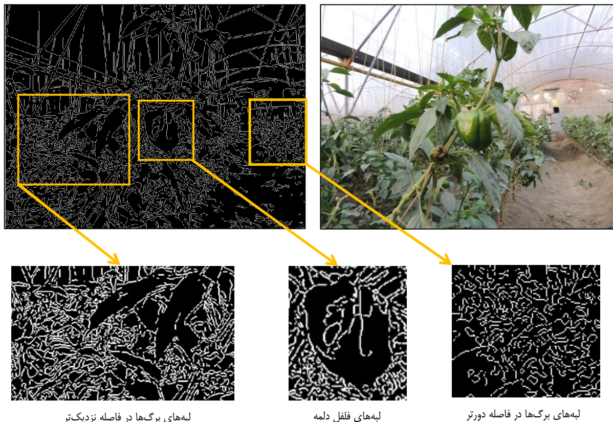
شکل ۳- لبه‌های تشخیص داده شده توسط الگوریتم کنی و تصاویر بزرگ‌نمایی شده لبه‌های فلفل دلمه و برگ‌ها
