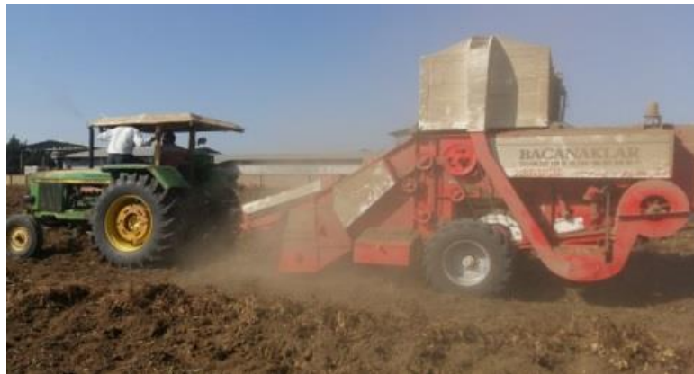
شکل ۴- برداشت مکانیزه بادامزمینی با کمباین کششی مخصوص Fig.4. Mechanized harvesting of peanuts by special pull type combine
