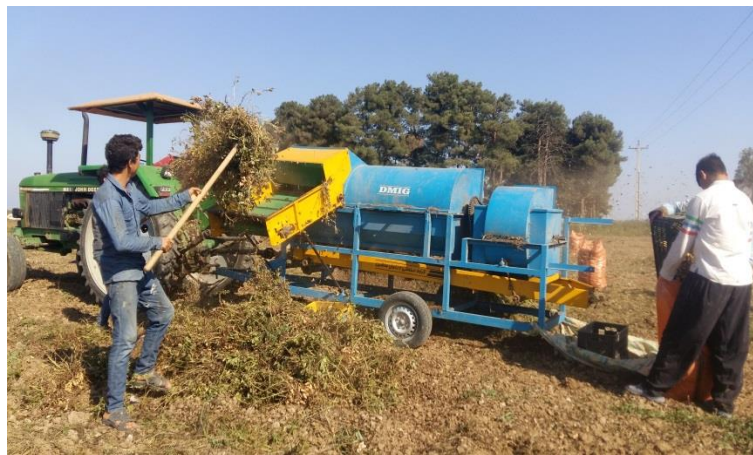
شکل ۳- برداشت نیمه مکانیزه بادامزمینی با خرمن کوب پشت تراکتوری Fig.3. Semi-mechanized harvesting of peanuts by tractor-mounted thresher
