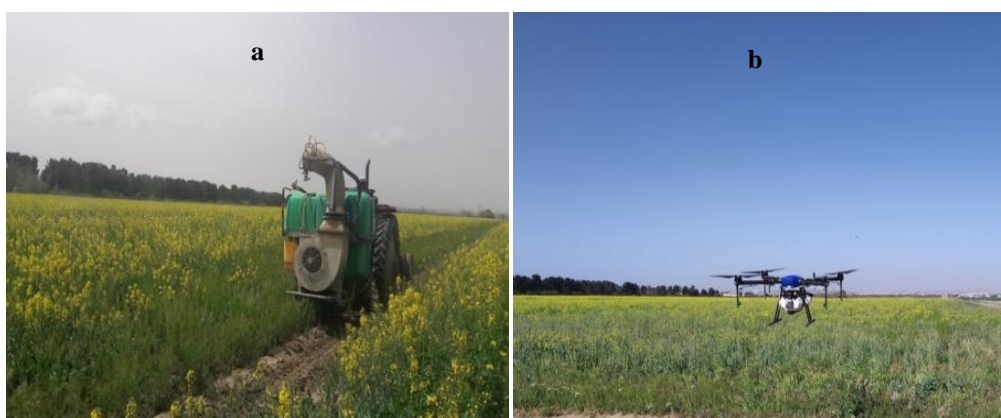
شکل ۲- سمپاش‌ها هنگام سمپاشی مزرعه کلزا (a: سمپاش توربولاینر، b: پهپادسمپاش)
