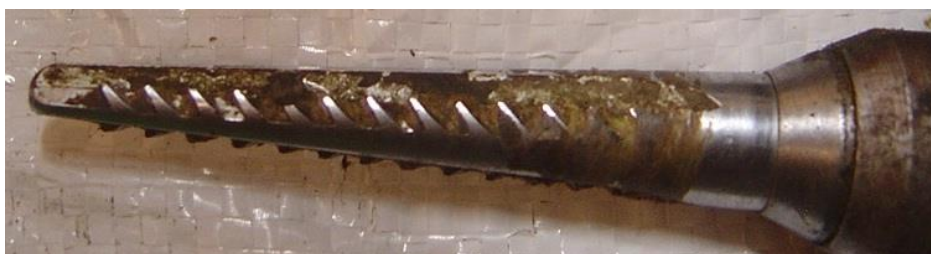
شکل ۶- سوزن ماشین برداشت پوشیده شده با بقایای برگ
